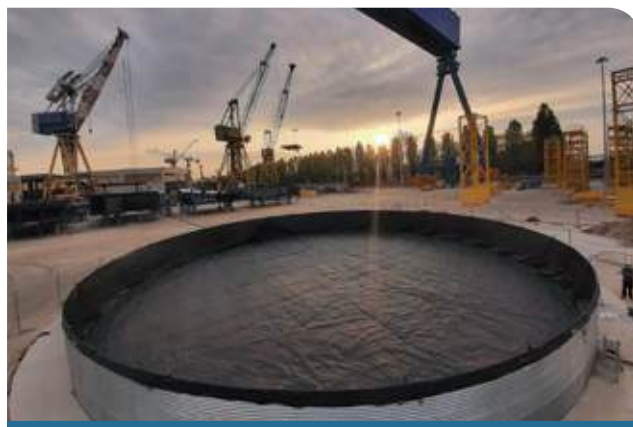
(Marghera, 2021) Oltre che per scopi ingegneristici, queste grandi vasche possono altresì essere impiegate, quali serbatoi antincendio, sempre in cantieri navali oppure negli impianti di biogas o di irrigazione, o riutilizzate per lavaggi di piazzali industriali e per il recupero delle acque piovane, infine persino per lo stoccaggio di olii naturali quali la sansa, ma NON per carburanti!
